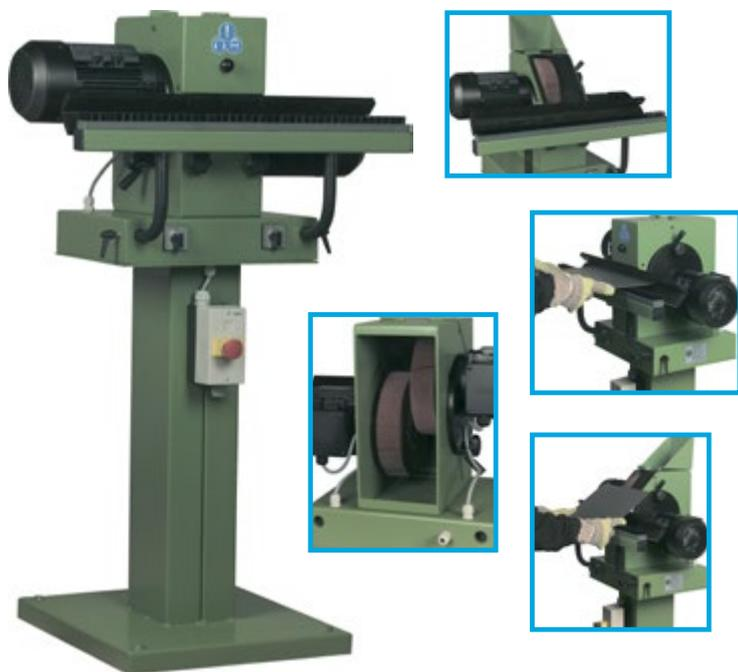
Станок для обработки кромки листового материала. Специальная конструкция обеспечивает эффективное и чистое удаление заусенцев с краёв на большинстве черных и цветных металлов с использованием двух абразивных лепестковых кругов. Круги вращаются в противоположных направлениях независимо друг от друга, могут снимать заусенцы либо на одном, либо на двух краях одновременно. Верхняя крышка станка открывается для шлифования и полирования плоских поверхностей.
