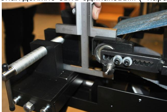
Рис.:3.5.1 Замер разницы между с контактным диском и столом держателя трубы.
